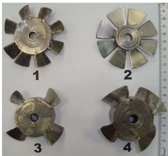
Рис. 10. Рабочие колеса с различной конфигурацией лопастной системы
