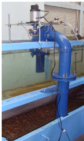
Рис. 4. Расчетная схема и фотоснимок модели микроГЭС
